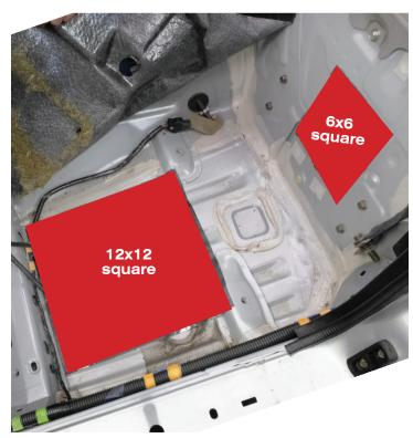
RECOMMEDNED LOCATION TO PLACE BOOM MAT DAMPING MATERIAL UNDER THE SEAT AND BEHIND DRIVER AND PASSENGER SEAT DRIVER SIDE SHOWN (VIEW FROM DRIVERS DOOR)
