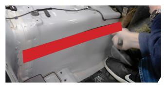
RECOMMEDNED LOCATION TO PLACE BOOM MAT TAPE DAMPING MATERIAL ON PASSENGER SIDE TRANS TUNNEL PASSENGER SIDE SHOWN (VIEW FROM PASSENGER DOOR)
