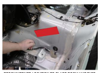
RECOMMEDNED LOCATION TO PLACE BOOM MAT TAPE DAMPING MATERIAL ON DRIVER SIDE TRANS TUNNEL DRIVER SIDE SHOWN (VIEW FROM DRIVERS DOOR)
