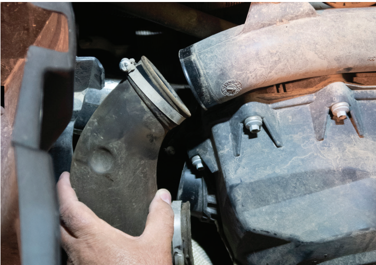
Fig. 15 - Remove CVT air elbow
